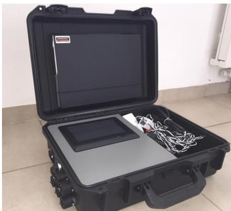
Sämtliche Anschlüsse der 2-4 Zähler sind nach außen geführt und gegen Verschmutzung geschützt.
